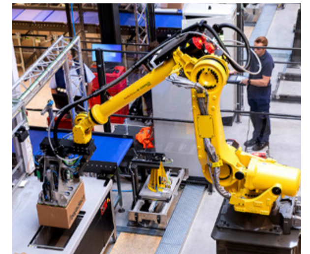
Ein Roboterarm stapelt die versandfertigen Pakete auf Paletten. Zwei dieser Maschinen sind im Einsatz.
